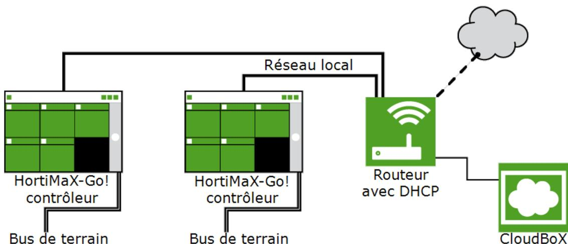
Figure 1-1: Diagramme de connexion réseau
